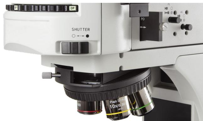
● Revolver con ranura per lamina Nomarski DIC
